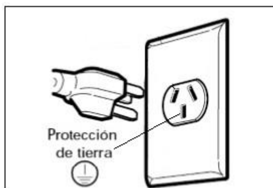
Descripción de tomacorriente con puesta a tierra para alimentación de 230V.
